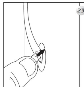
Stecken Sie den Griff beidseitig zusammen und fixieren Sie diesen mit den Schrauben 3x20 mm. Anschließend verdecken Sie die Schraube mit den beiliegenden Kappen.
