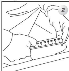
2 Übertragen Sie die Maße auf die Laufschiene und kürzen Sie diese dementsprechend mit einer Metall-Hand-Säge
