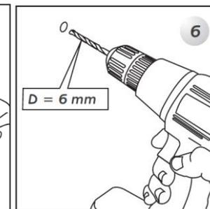
5 Bohren Sie die mit einem 6mm Stein-Bohrer die angezeichneten Löcher
