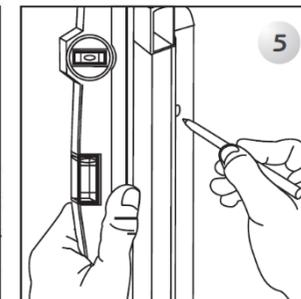
4 Bringen Sie diese in Waage und übertragen Sie die Bohrlöcher
