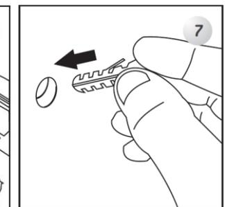
6 Setzen Sie die mitgelieferten Dübel in die Bohrlöcher
