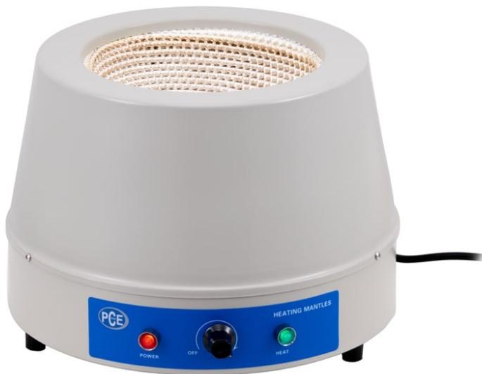
Die Heizhaube ist ein Hilfsgerät, welches in Laboratorien Anwendung findet. Die Heizhaube hilft Ihnen dabei verschiedene Proben oder Chemikalien im Labor zu erhitzen bzw. temperieren. Das Gerät verfügt über ein gehäkeltes Netz im Inneren, in welches man den Rundkolben einhängen kann um ihn dann zu erhitzen. Der Rundkolben ist die typische Form der Glasgefäße, die in die Heizhaube gestellt werden.
