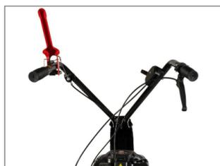
Radantrieb und Messerbalken separat Zuschaltbar
